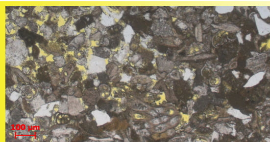
Microscopische foto van Bateig Azul onder gekruiste polarisatoren (foto WTCB).
